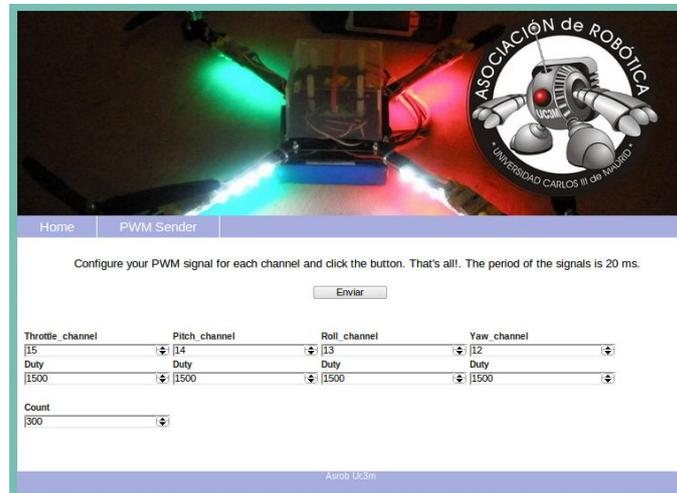
Fig. 7. Pestaña PWM Sender de la interfaz del robot UAV (versión completa)
